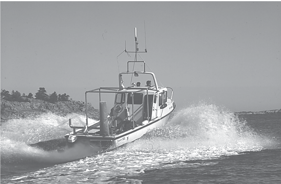
SFC 2388 Dykdator. Längd 8,85 m, bredd 2,7 m, djupgående 0,8 m. Motor: 6 cyl turbo-diesel på 192 hkr. Fart: 18 knop. Byggnadsmaterial: glasfiberarmerad plast. Utrustning: dagsljusradar, mobiltelefon, VHF-telefon, skrivande 200 kHz, ekolod, GPS satellitnavigator, GPS mottagare, DECCA-navigatör, trackplotter, autopilot, protonmagnetometer, hydraulisk kran, fällbar dykstege/plattform i aktern. Torleif Nilssons båt som användes vid inventering av östgötakusten. Foto Thorleif Nilsson.
